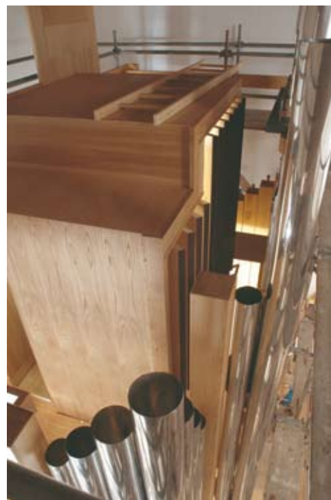
Das Schwellwerkgehäuse mit seinen drehbaren Lamellen zur Lautstärkenregulierung wird von den Prospektpfeifen verborgen.
