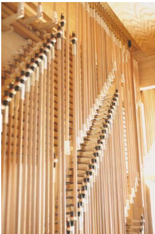
Blick auf das Wellenbrett hinter der Hauptwerkswindlade. Hier wird die mechanische Verbindung zu den Tasten auf die Pfeifen verteilt.
