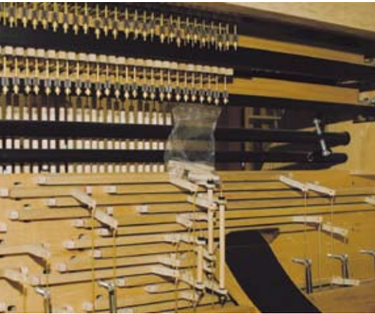
Die Mechanik für die Pedalkoppeln im Spieltisch. Unten rechts ist das Schwellpedal zu sehen.
