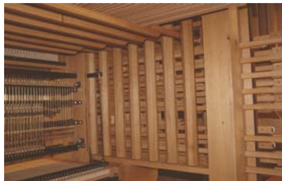
Blick auf den Koppelbau des Spieltischs (links) und die Registerwellen zur Hauptwerkwindlade. Oben sind die Abstrakten der Spieltraktur zu sehen.
