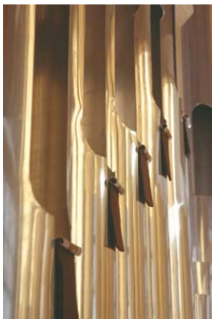
Ansicht der Prospektpfeifen vom Stimmgang aus. Oberhalb der Stimmrollen sind die Pfeifenkörper ausgeschnitten; diese optische Überlänge hat keinen Einfluss auf die Tonhöhe.
